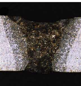
Příčný řez svarem titanu a 3D axonometrie profilu svaru titanu: a) povrch, b) kořen (Talysurf).
