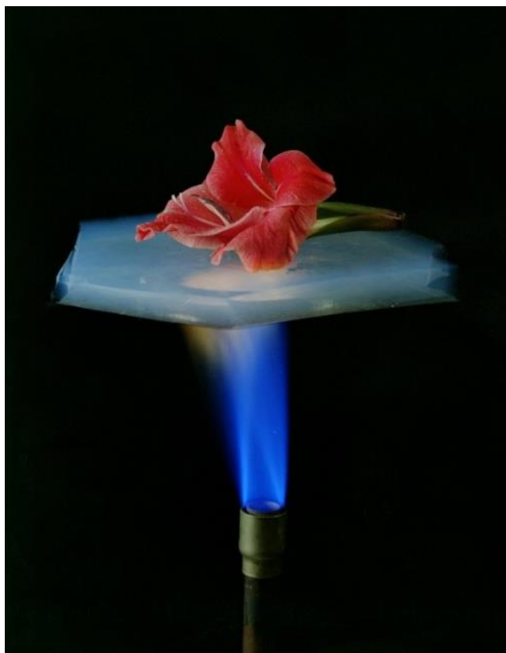
Obrázek č. 26: Aerogel – ideální tepelně izolační materiál (image credit Lawrence Berkeley National Laboratory)
