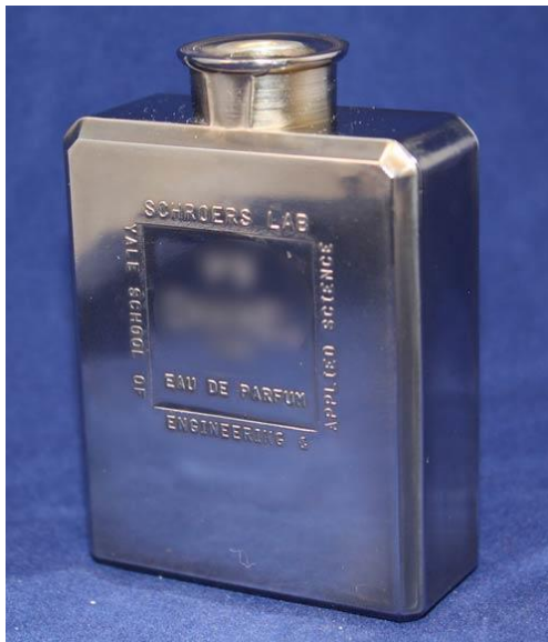
Obrázek č. 15: Flakón na luxusní parfém ( tloušťka stěny 0,3 mm)
