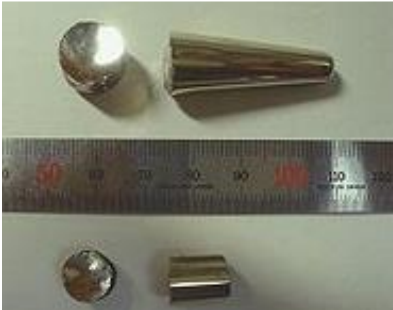
Obrázek č 14 : Kovové sklo v těchto rozměrech je vyrobitelné až v posledních letech
