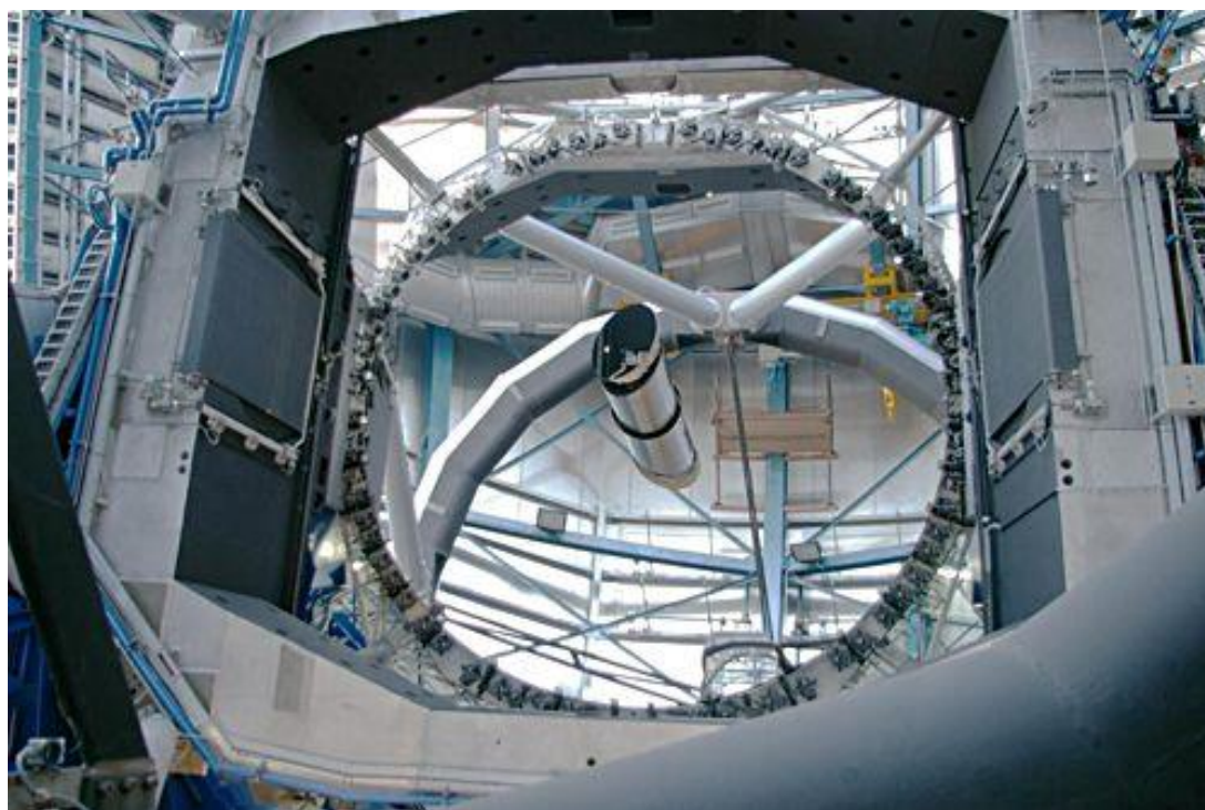
Obrázek 12 : Největší monolitická zrcadla astroteleskopů o průměru 8,2 m jsou základem Dalekohledových čtyřčat přístroje Very Large Telescope, který postavila ESO v Chile, tato zrcadla byla vyrobena ze sklokeramiky ZERODUR s hodnotou koeficientu roztažnosti \alpha = 0 \pm 0.02 \cdot 10^{-6}/K http://www.futura-sciences.com
