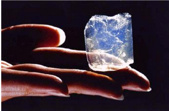
Obrázek č. 25: A classic silica aerogel monolith (image credit Prof. C. Jeffrey Brinker)
