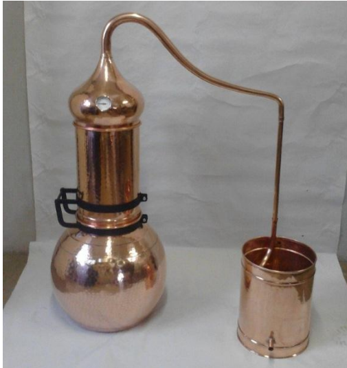
Obrázek 18: Využití mědi pro její vynikající tepelnou vodivost pctuning.tyden.cz , http://www.alkoholesence.cz
