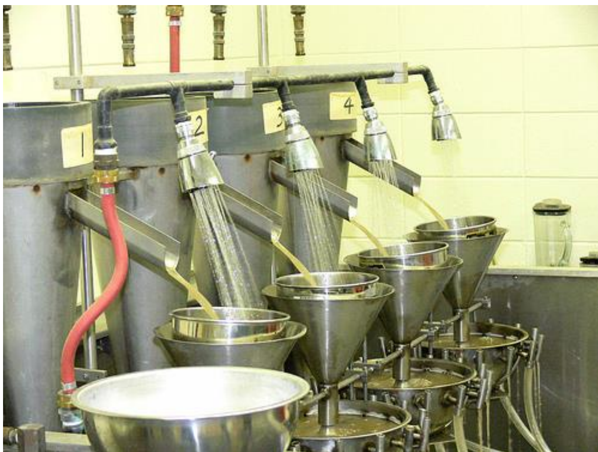
Obr.č.48: Kolona k třídění zrn pomocí elutriace ( mokrý postup )
