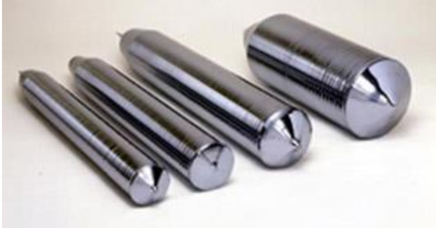
Obrázek č. 13: Syntetické monokrystaly křemíku – materiál pro výrobu elektronických čipů
