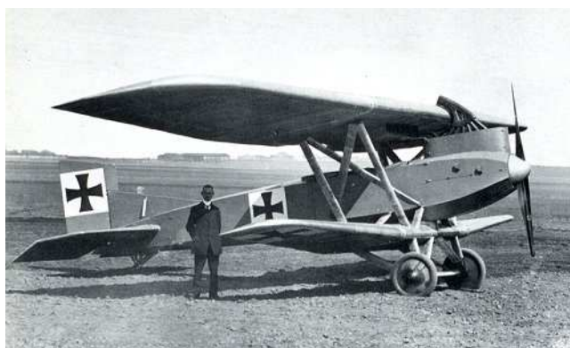
Obrázek č.6: Celokovový Junkers J.I bitevní letoun o hmotnosti 1766 kg
