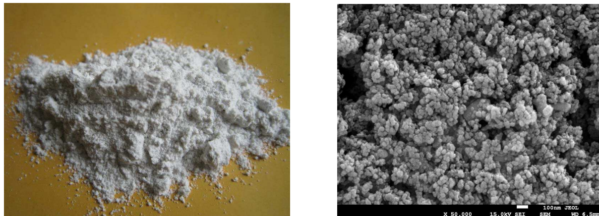
Obrázek č.2: Alumina – modifikace \alpha - \text{Al}_2\text{O}_3
