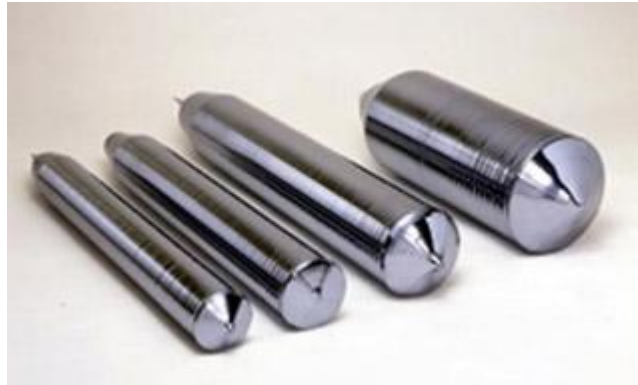
Obrázek : Syntetické monokrystaly křemíku – materiál pro výrobu elektronických čipů
