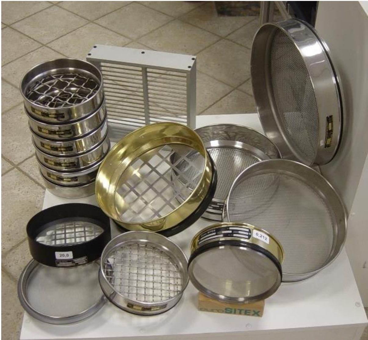
Obr. 20: Nejstarší metodou třídění sypkých materiálů je síťování, velikost ok je dána počtem na plochu nebo rozměrem otvoru a nebo je to jinak. Je třeba pamatovat, že ne všude je běžný metrický systém.
