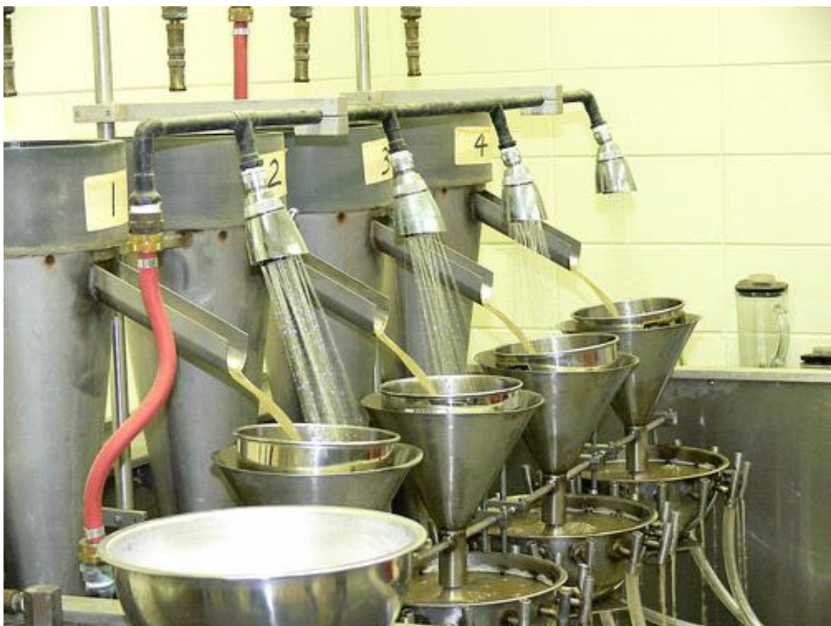
Obr.21: Kolona k třídění zrn pomocí elutriace ( mokrý postup )
