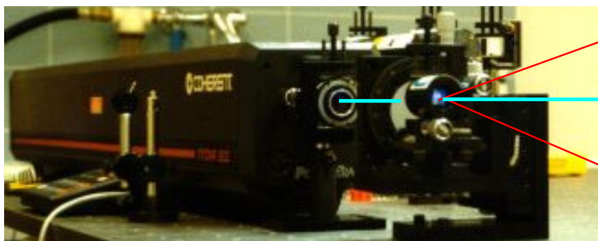
Kr laser @ 413 nm, 200 mW, vertikální polarizace
