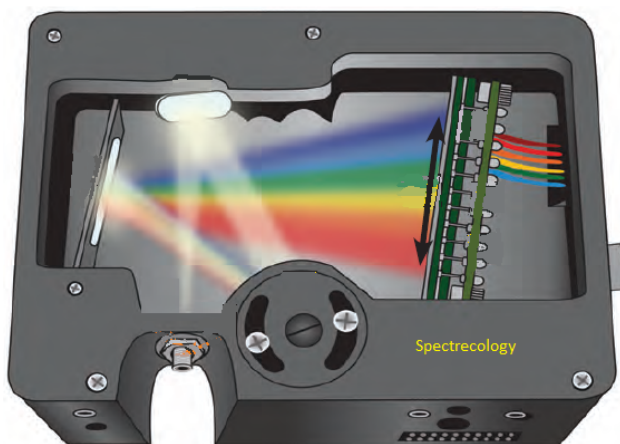
Obrázek 7.25: Schéma spektrometru Flame od firmy Ocean Optics. Difrakční mřížka je umístěna v otočné montáži. Po zafixování rotace dvěma šroubky je třeba spektrometr nakalibrovat. Převzato z webu Ocean Optics [24].
