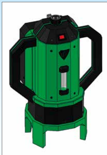
Návrh prototypu austenitometru
