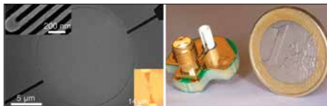
Obr. 5 Vlevo snímek z elektronového skenovacího mikroskopu meandru z nanodrátku, vpravo senzor s vláknovým konektorem a SMA elektrickým konektorem. Převzato z ref. [11]
